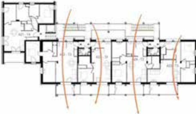
© Adminima architecture / Rhône Saône Habitat - La desserte par une coursive permet d'avoir 100% de logements traversants
